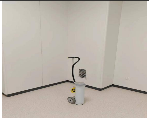
图2 紧急储源罐、长柄夹子及排风口
